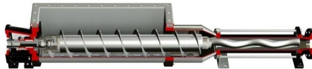
Versão com moega retangular, com proteção de juntas e sem-fim largo alimentando a parte hidráulica. Adequado para bombear substâncias com fluxo fraco até 28% de substâncias secas de alta viscosidade que não tendem a formar pontes.
