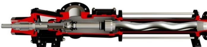
La motorizzazione è accoppiata direttamente alla pompa tramite flangia del modulo supporto cuscinetti. Questa soluzione è la più versatile in quanto permette l'utilizzo di riduttori con flangia e albero di uscita standard, l'accoppiamento con motori idraulici o pneumatici, mantenendo la semplicità e compattezza della classica soluzione monoblocco ed allo stesso tempo garantendo totale reversibilità e le prestazioni superiori del supporto cuscinetti.
