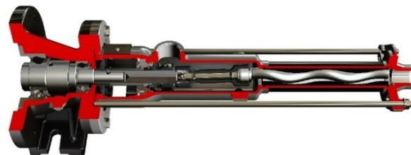
La motorizzazione è accoppiata direttamente alla pompa tramite flangia del modulo supporto cuscinetti. Questa soluzione è la più versatile in quanto permette l'utilizzo di riduttori con flangia e albero di uscita standard, l'accoppiamento con motori idraulici o pneumatici, mantenendo la semplicità e compattezza della classica soluzione monoblocco ed allo stesso tempo garantendo totale reversibilità e le prestazioni superiori del supporto cuscinetti.
