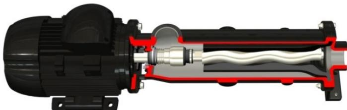
La Série RL est un produit très compact grâce à la construction intégrée de la pompe et du moteur électrique. Elle est dotée de l'articulation brevetée de la Série Diamond, garantie d'une fiabilité à toute épreuve. L'absence du support entre le corps de la pompe et la commande pour davantage de compacité et de simplicité de maintenance.
