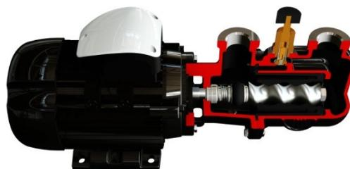
La Série R est le produit le plus compact disponible grâce à la construction intégrée de la pompe et du moteur électrique, ainsi qu'une partie hydraulique extrêmement courte. Elle utilise une articulation à croisillons, fiable et simple à entretenir. L'absence du support entre le corps de la pompe et la commande pour davantage de compacité et de simplicité de maintenance.
