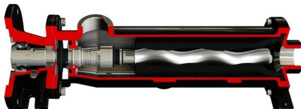
La Série RFL se base sur la même technologie de la série RL. Elle se différencie par l'utilisation d'un support à roulements avec arbre creux à l'entrée. La série RFL peut être branchée directement à la commande avec une bride. La solution idéale pour la fourniture de la pompe sans motorisation, tout en maintenant la compacité et la simplicité d'installation. Les roulements garantissent une fiabilité maximale dans toutes les conditions d'exploitation.
